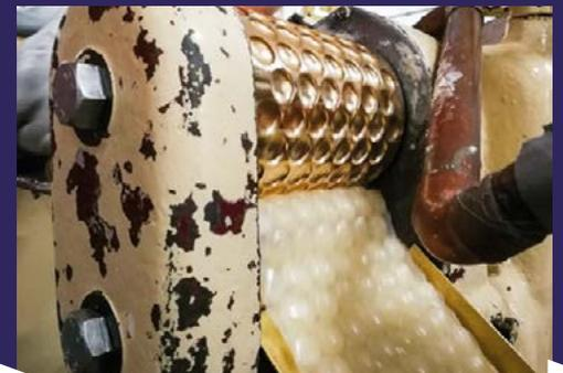
Der Kegelroller formt die Masse zu einem langen Strang. Davon werden nun kleine Bonbonportionen abgeteilt und von einer Prägemaschine in lutschbare Form gebracht.
